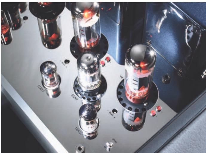
Die mittelgroßen Röhren stabilisieren die Vorstufen-Speisespannung. Wenn beide LEDs bei den Endröhren glimmen, stimmt der Arbeitspunkt.
