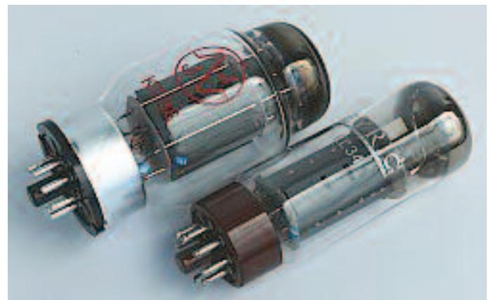
2 Röhrentypen - 2 unterschiedliche Klänge: links KT 88, rechts EL 34
