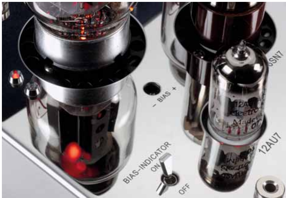
Der Ruhestrom jeder Endstufenröhre lässt sich feinfühlig einstellen. LEDs helfen dabei
