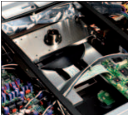
Gepackt: Das VRDS-Laufwerk spannt die CD oder SACD ein. Es lässt keine Bewegung der Scheibe außer Drehen zu.
