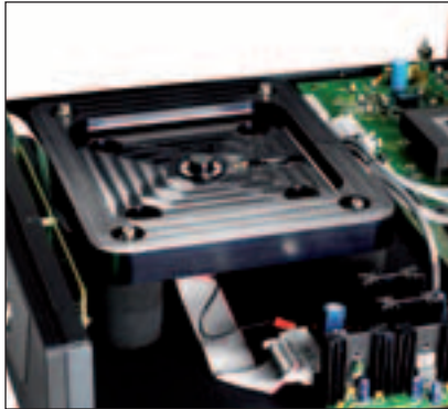
Gepanzert: Das Laufwerk CDP Pro2 von Philips wird gegen Störeinflüsse rundum abgeschirmt und auf Federn gelagert.
