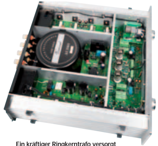
Ein kräftiger Ringkerntrafo versorgt die pro Kanal vier Endstufen-Transistoren. Die Röhren-bestückte Vorstufe steckt hinter der Front.
