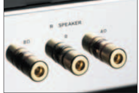
Wie am Cayin und am PrimaLuna bieten auch am T.A.C. die Ausgangstrafos eigene Abgriffe für Vier- und Acht-Ohm-Lautsprecher.
