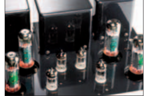
Die Endröhren EL 34 des Foto-Musters (links und rechts) stammen von Electro Harmonix. Im Test standen auch chinesische Modelle.
