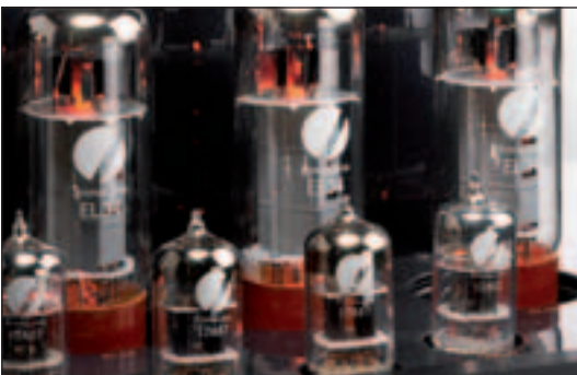
Den Endröhren EL 34 schaltet der ProLogue One die gleichfalls bewährten Doppeltrioden 12AX7 und 12AU7 vor.
