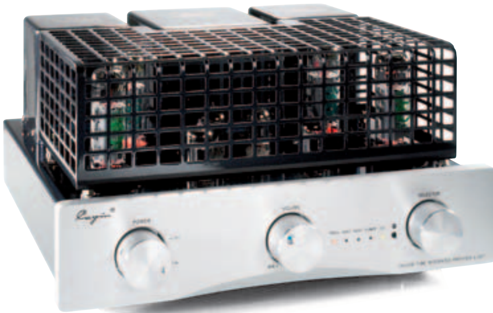
Die Endröhren EL 34 des Foto-Musters (links und rechts) stammen von Electro Harmonix. Im Test standen auch chinesische Modelle.
