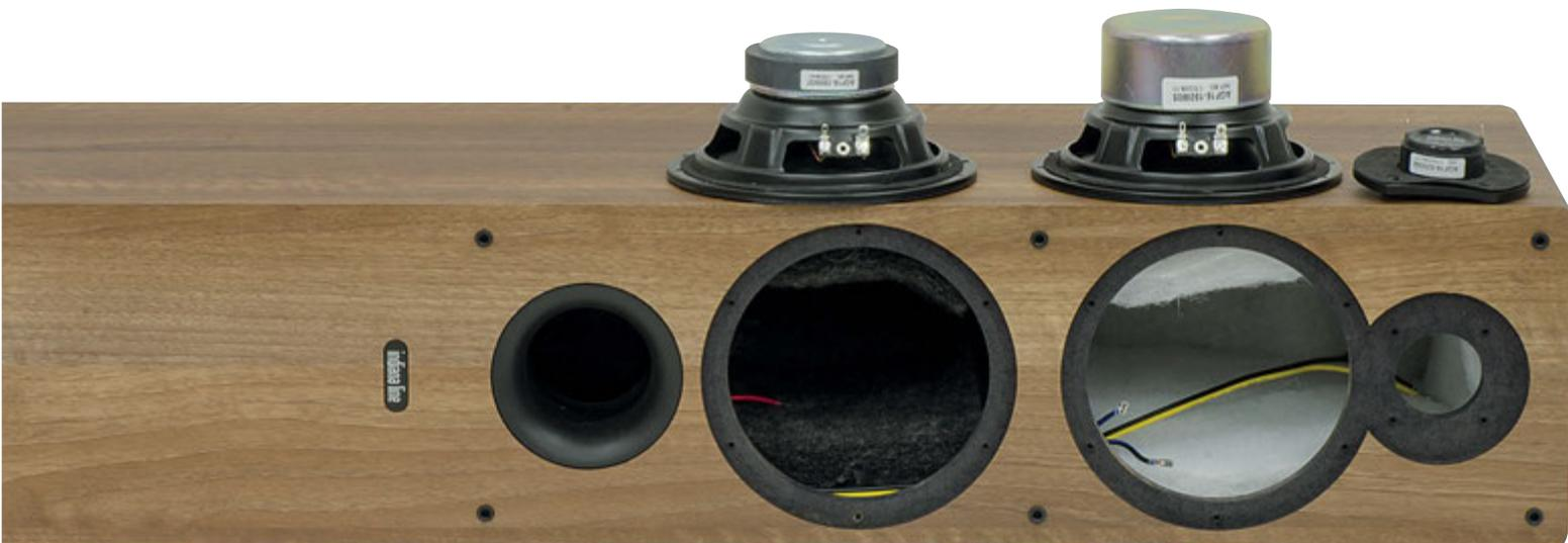
Notiamo il woofer inferiore con un solo anello magnetico ed il woofer-midrange che ha due anelli magnetici e la schermatura per avere una performance migliore in gamma media. Il tweeter ha un anello di neodimio e la cupola morbida. Alle spalle della cupola è sistemata una cavità che smorza le onde stazionarie createsi.
