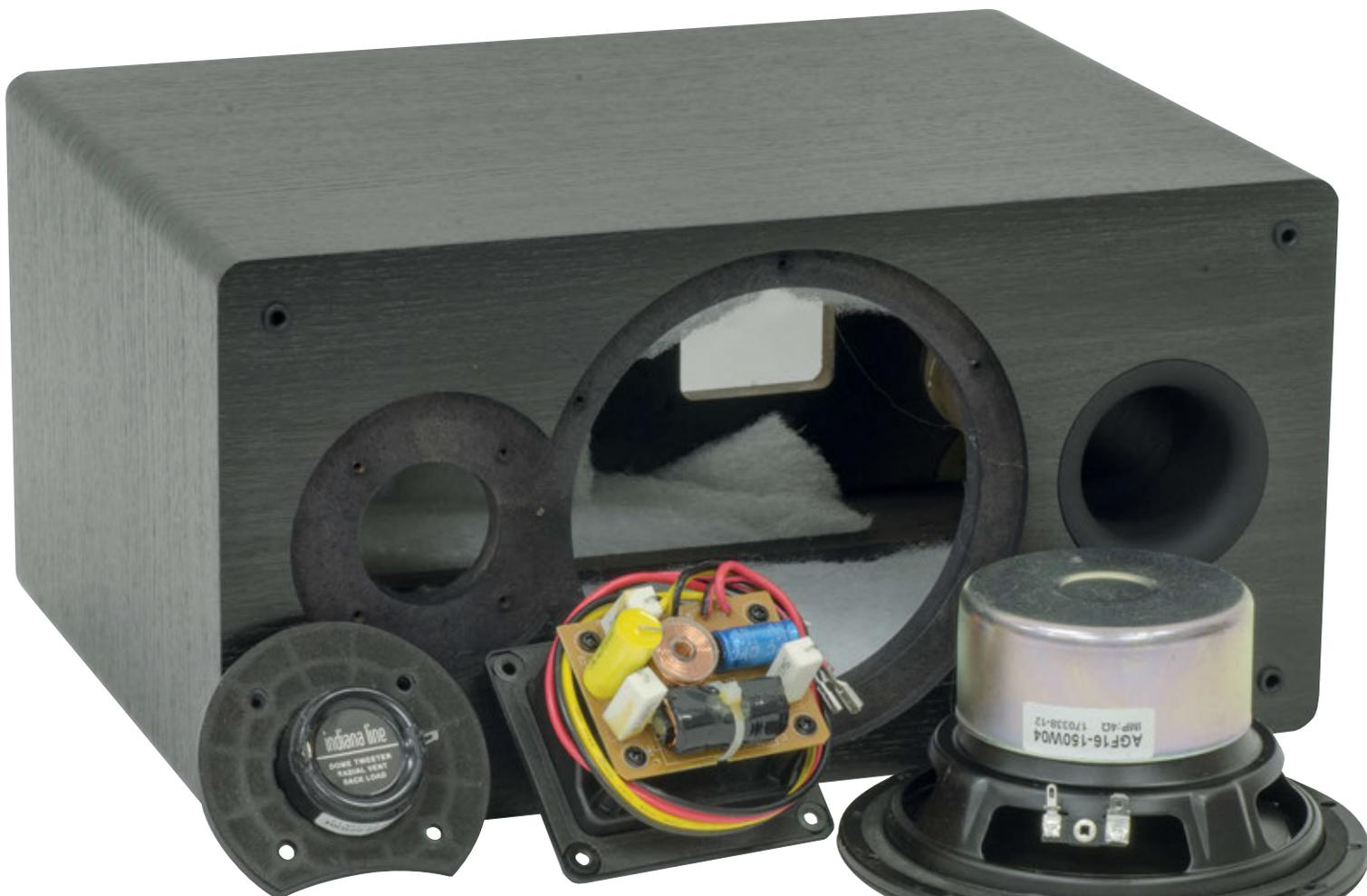
*Il diffusore completamente smontato. Notare l'assorbente acrilico, il filtro crossover sulla vaschetta portacontatti e la schermatura del complesso magnetico del woofer.*
