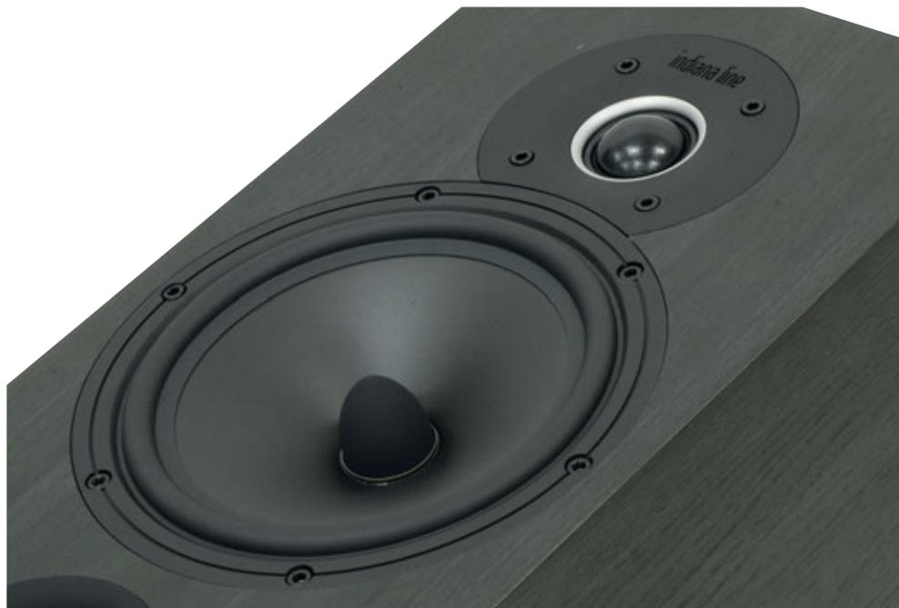
*Un bel primo piano dei due trasduttori. Notare la flangia del tweeter curvata al di sotto della cupola per avvicinare i centri acustici dei due altoparlanti, la membrana in polipropilene irrigidito del woofer e la cupola in seta del tweeter.*
