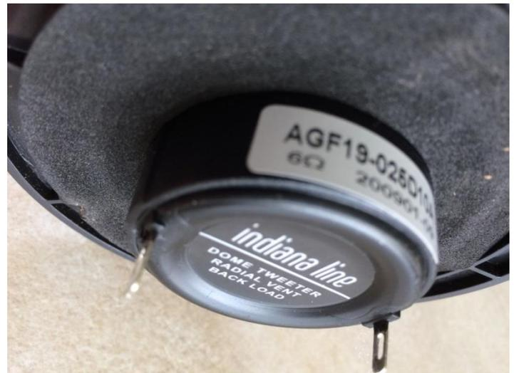
Den Antrieb übernimmt ein kräftiges Neodym Magnetsystem (Bild rechts oben). Die Membran arbeitet auf ein genau berechnetes Volumen. Das Ergebnis ist eine klare, schön definierte Hochtönwiedergabe ohne jeglichen Hang zur Schärfe.
