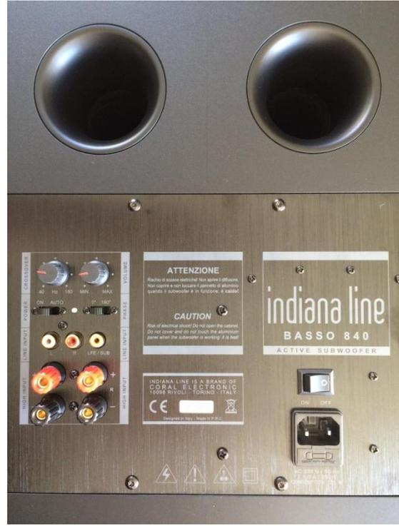
Danach schweift unser Blick zur Rückseite. Zunächst fallen zwei „Endrohre“ ins Auge. Sie bilden die Bassreflexöffnung in **Twin-Reflex Technologie**. Diese ermöglicht einen kraftvollen, tiefen Bass, bei gleichzeitig deutlich minimierten Strömungsgeräuschen gegenüber einer herkömmlichen Bassreflexkonstruktion. Wer ganz genau hinschaut erkennt auf dem rechten Bild, in Bildmitte, wie sauber und genau die umlaufende Vinyl Folie verklebt und verarbeitet ist.
