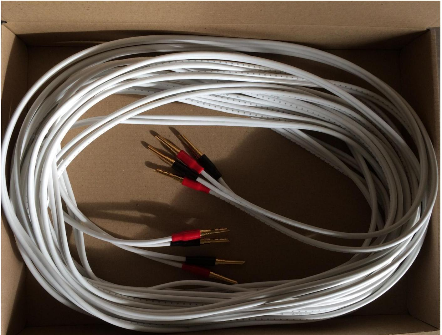
Der strukturelle Aufbau ähnelt im Ansatz den Melodika Kabel (Purple Rain/Gunmetal). In der Mitte befindet sich ein etwas dickerer Leiter aus sauerstofffreiem OFC-Kupfer. Dieser ist umgeben von 204 versilberten OFC-Kupferleitern, so dass sich ein Querschnitt von  $2 \times 2,5 \text{ mm}^2$  ergibt. Die Ummantelung besteht aus PVC. Das Kabel ist laufrichtungsgebunden. Durch die weiße Farbe ist es relativ dezent und die hohe Flexibilität erleichtert oftmals den Anschluss.
