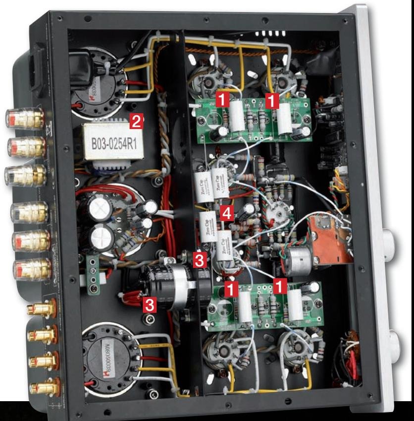
Wo in den Ti 60 nun soviel Arbeit reingesteckt war, sollte es beim Finish nicht fehlen. So leistete sich Lyric wie bei seinen größeren Amps eine superordentliche Verdrahtung, die sich zumeist nur an keramischen Röhrensockeln und ebensolchen Lötleisten abstützt. Oder das Honig-Drehgefühl, das erst der große, selbstredend auch fernbedienbare Alps-Lautstärkerregler garantiert.
