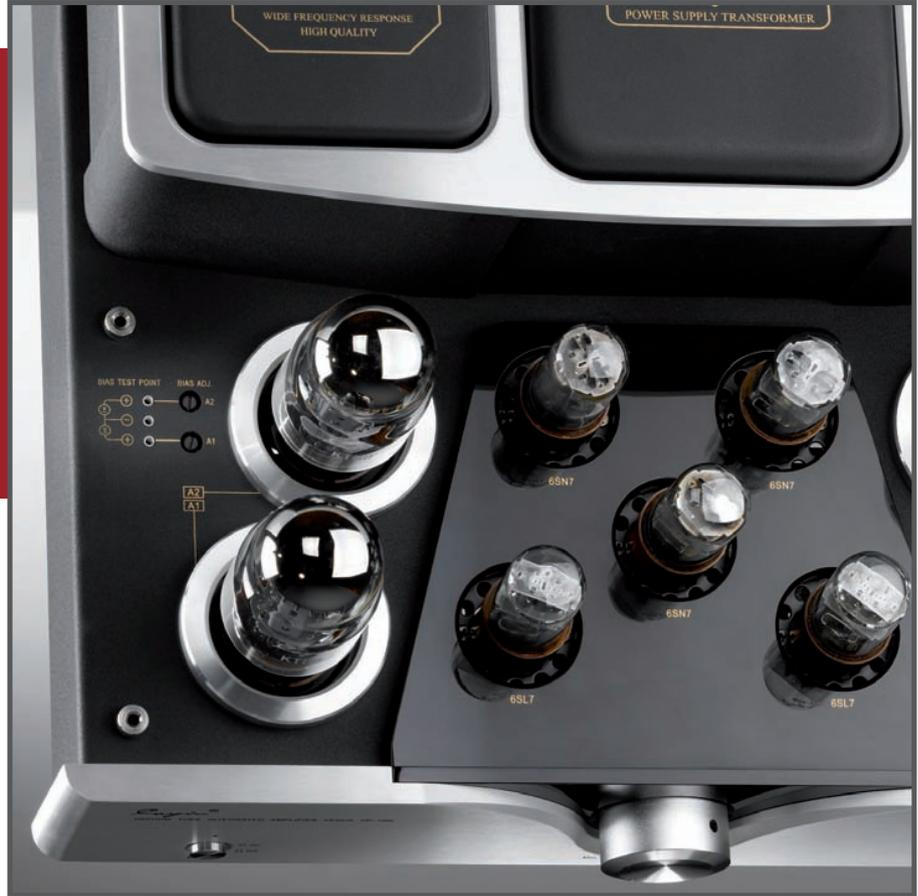
Mit Abgriffen für ein Voltmeter und von außen zugänglichen Stell-schrauben neben den pro Kanal zwei KT88-Endröhren (links) lässt sich der Bias des Cayin anpassen.
