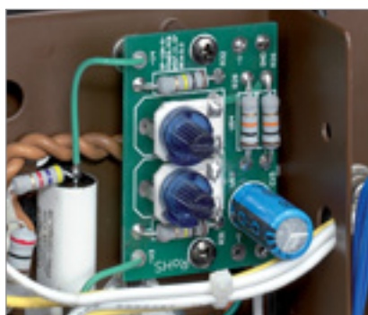
Die Ruhestromeinstellung (einstellbare Gittervorspannung) für ein Röhrenpaar
