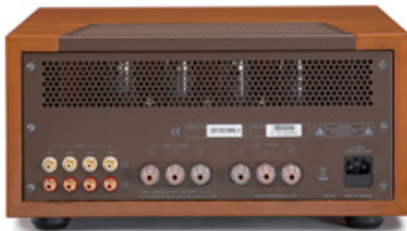
Ausreichende Lüftungsöffnungen garantieren „kühle“ Röhren. Die Lautsprecherklemmen sind voll isoliert, die Cinchbuchsen von guter Qualität
