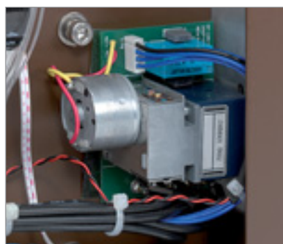
Das Alps-Motorpoti reagiert schnell und leise auf die Fernbedienung
