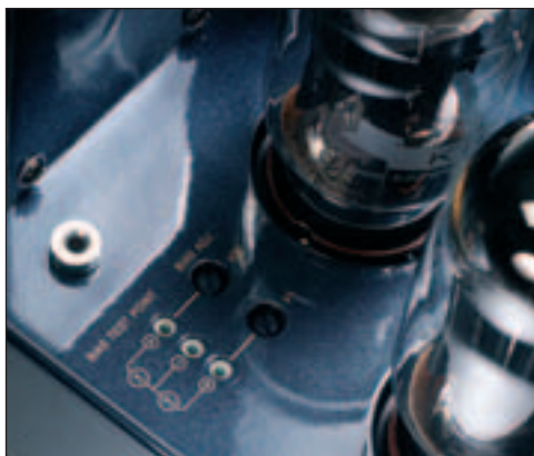
Ruhestromkontrolle: an den Trimpotis nachziehen, bis ein Multimeter 400 Millivolt anzeigt.
