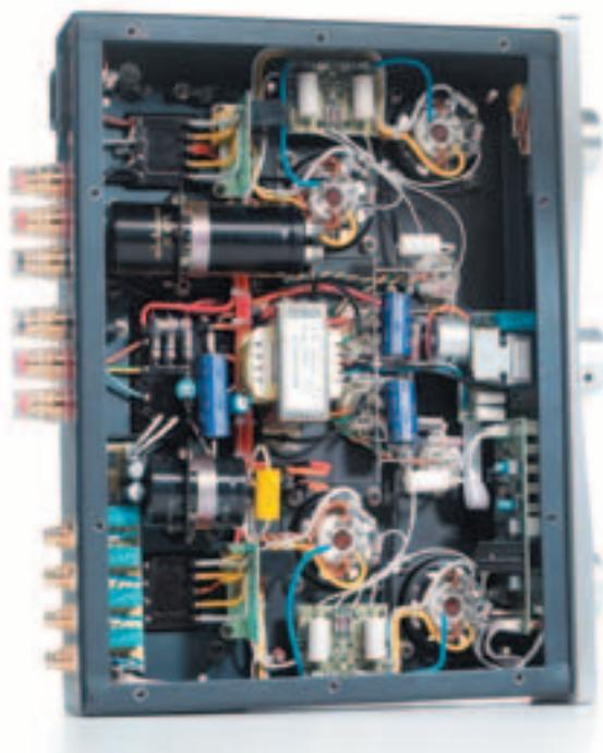
**A 50 T:** Die Eisenkern-Drossel (Mitte) sorgt zusammen mit den großen Elkos (470 und 330 Mikrofarad bei 450 und 500 Volt) für eine sehr saubere Hochspannung.
