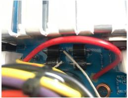
Alles beginnt mit dem großzügig dimensionierten Ringkerntrafo (links oben). Sekundärseitig gehen die Kabel in der Mitte des Kühlkörpers zur Platine. Einzelne, schnelle Dioden (Detailbild links) sorgen für die positve und negative Gleichspannung. Diese wird mit Hilfe der beiden Kondensatoren (20.000 Mikrofarad Siebkapazität, Bildmitte) geglättet und stabilisiert. Mit +/- 29 Volt werden die beiden Paare (je Kanal) der sehr angesehenen Sanken Transistoren, spannungstechnisch versorgt.
